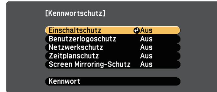
Falls dieses Menü nicht angezeigt wird, halten Sie die [Freeze]-Taste an der Fernbedienung 5 Sekunden lang gedrückt, bis das Menü erscheint.
