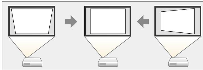
Über die Trapezkorrektur-Tasten können Sie Bilder um bis zu 30 ° nach rechts, links, oben oder unten korrigieren.
