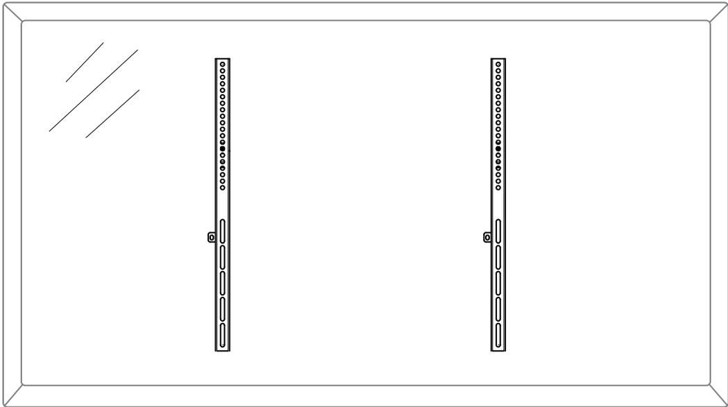
Montieren Sie die VESA-Arme rückseitig am Bildschirm. Schrauben bitte vorsichtig einschrauben und anziehen um Beschädigungen zu vermeiden. Verwenden Sie passende Schrauben aus dem mitgelieferten TV-Schrauben-Beutel. Bei der B2B-Varainte wiederholen Sie diesen Schritt für beide Bildschirme.
