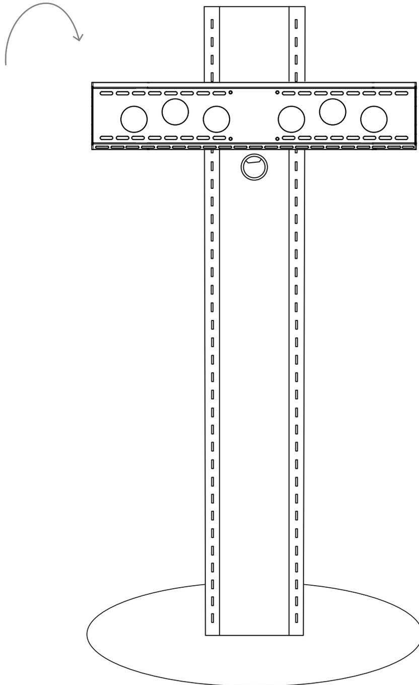
Hängen Sie die VESA-Aufnahme / VESA-Montageplatte in der gewünschten Höhe in die Raststufen der Säule ein.
