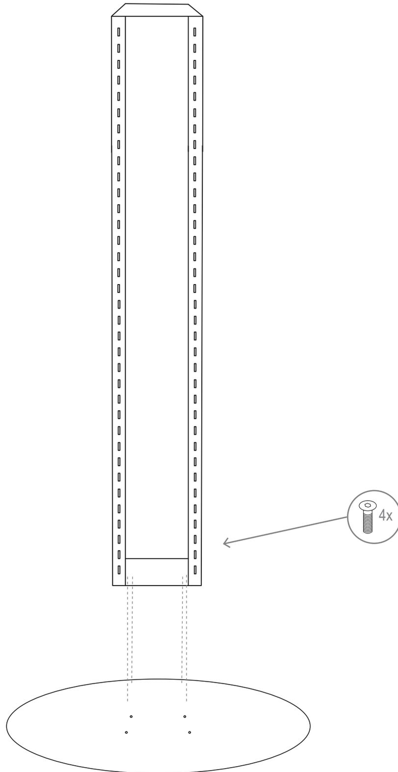
Legen Sie die Standsäule auf eine weiche Unterlage um Beschädigungen zu vermeiden. Verschrauben Sie die Bodenplatte mit der Standsäule, verwenden Sie hierfür die M8X40 Senkkopfschrauben. Richten Sie die Säule anschließend vorsichtig auf.
