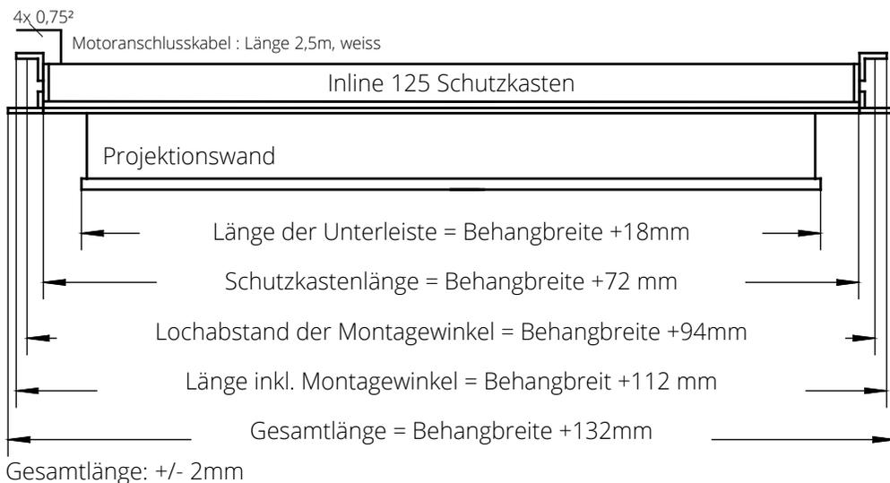
Alle Projektionswände im System Inline sind auch als Version für den Deckeneinbau lieferbar. Für den komfortablen Zugang zu den Befestigungsschrauben bei Montage und Service sind die beiden seitlichen Winkel abnehmbar. Montage und Demontage der Projektionswand ist ohne zusätzliche Deckenöffnung möglich!
