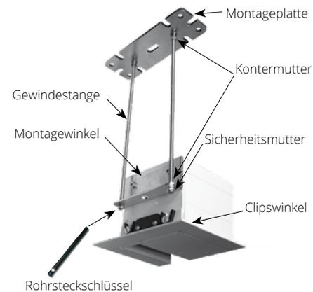
Alle Projektionswände im System Inline sind auch als Version für den Deckeneinbau lieferbar. Für den komfortablen Zugang zu den Befestigungsschrauben bei Montage und Service sind die beiden seitlichen Winkel abnehmbar. Montage und Demontage der Projektionswand ist ohne zusätzliche Deckenöffnung möglich!
