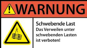
Die Rollbildwand ist entsprechend dem Gesamtgewicht während des Transportes und der Montage zu sichern. Bei Hubarbeiten dürfen sich im Gefahrenbereich unterhalb der schwebenden Last (Rollbildwand) keine Personen aufhalten! Es muss eine Sicherung gegen Absturz und eine gleichmäßige Gewichtsverteilung erfolgen!
