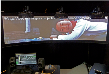
Kurzdistanzprojektoren an der Projektorenhalterung befestigt
