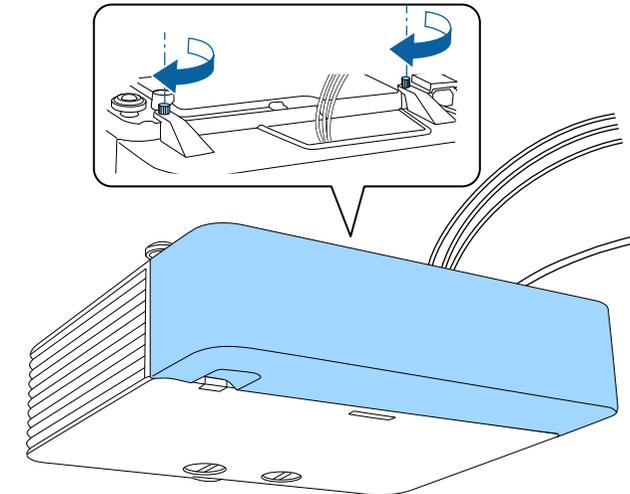
Entfernen Sie die Abdeckung, indem Sie die Abdeckungsschrauben lösen und die Abdeckung vom Projektor abziehen.
