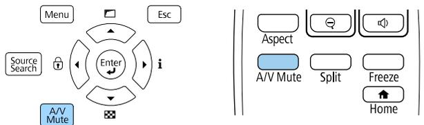
Die Lichtquelle schaltet sich aus und das projizierte Bild und der Ton werden unterbrochen.
