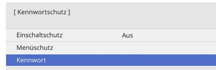
Falls dieses Menü nicht angezeigt wird, halten Sie die [Freeze]-Taste an der Fernbedienung 5 Sekunden lang gedrückt, bis das Menü erscheint.
