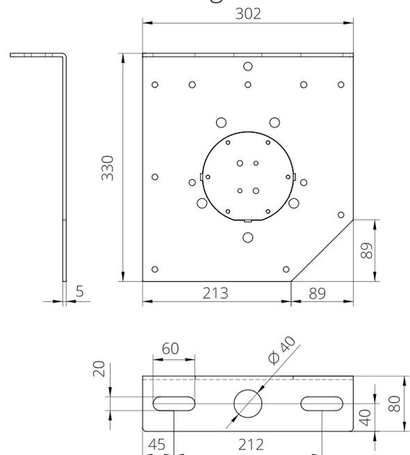
DIE BEFESTIGUNGSWINKEL DER PROJEKTIONSWAND SIND MIT DER DECKENKONSTRUKTION
