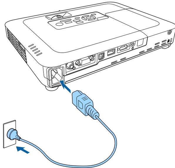
Die Betriebsanzeige des Projektors wird blau. Dies zeigt an, dass der Projektor mit Strom versorgt wird, aber noch nicht eingeschaltet ist (er befindet sich im Standby-Modus).
