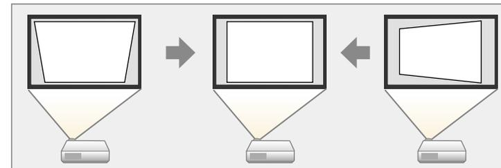
Über die Trapezkorrektur-Tasten können Sie Bilder um bis zu 30° nach rechts oder links bzw. 45° nach oben oder unten korrigieren.
