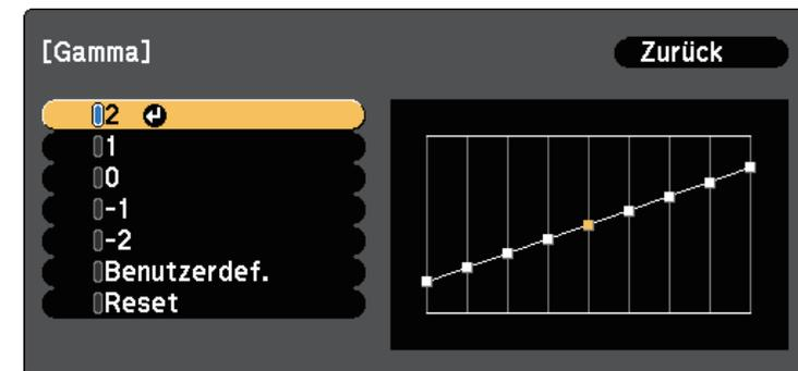
Durch Auswahl eines kleineren Wertes können Sie die Gesamthelligkeit des Bildes reduzieren, damit es schärfer dargestellt wird. Durch
