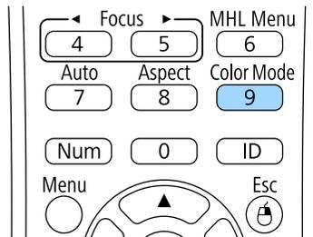
Der Name des Farbmodus wird kurz auf dem Bildschirm angezeigt und das Aussehen des Bildes ändert sich.
